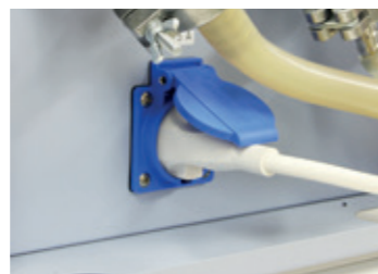
Zásuvka pro připojení a ovládání vývěvy
