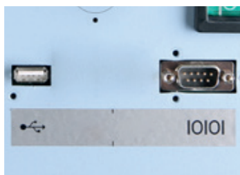
Ports de communication RS 232 et USB host
